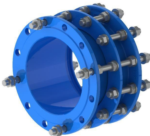
Typ 92 , fullt antal gängstänger för packningskompression och reducerat antal genomgående gängstänger mellan flänsarna
