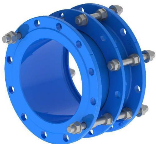
Typ 93 , varannan flänsbultshål försett med gängstång, två långa och övriga korta, ej dragfast utförande
