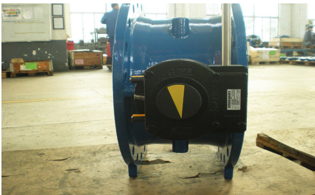
Kontroll av positionsindikator – steg 4
