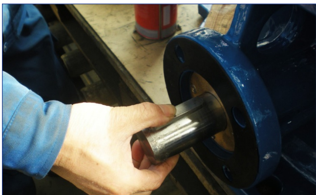
Byte av O-ring – steg 1
