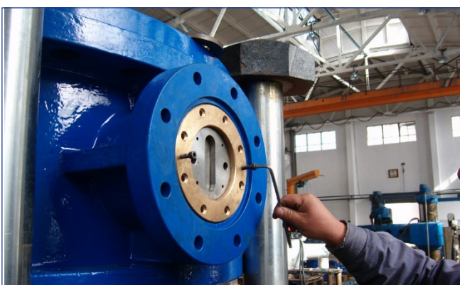
Byte av O-ring – steg 2
