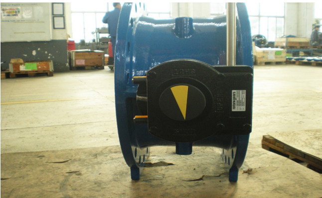
Kontroll av positionsindikator – steg 4
